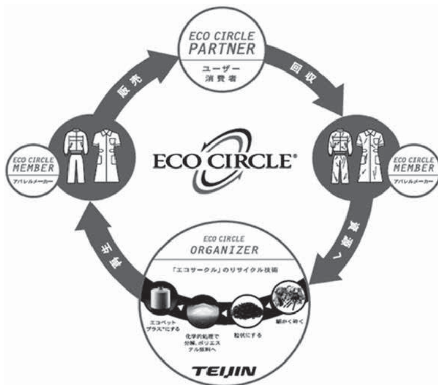
図2：エコサークルの仕組み (出所) 帝人株式会社ホームページ 2
