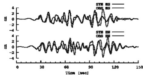
図 1 東京本郷における推定地震動と観測記録（太線が推定、細線が観測）
